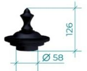
**Штык для установки светильников на грунт**
